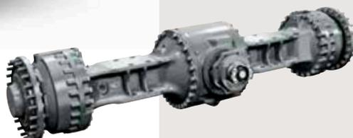
**Powertrain:** fabbricato con estrema precisione e sfruttando le migliori tecnologie, l'efficiente gruppo motopropulsore Doosan monta cambio PowerShift e assali per impieghi gravosi, con vantaggi che superano la semplice somma delle sue parti individuali. Freni a disco a 6 elementi assicurano operazioni sicure e precise nelle applicazioni pesanti.
