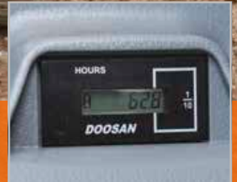
Betriebsstundenzähler (vom Boden aus ablesbar)
