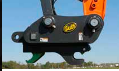
SCHNELLWECHSLER MIT BOLZENBEFESTIGUNG
