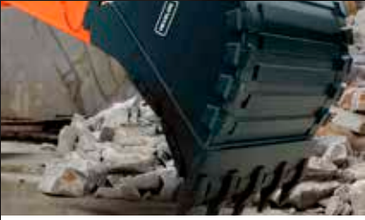
CUCHARAS CLASE S DEVELON (ROCAS DE MENOR DUREZA)
