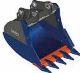
El cucharón para condiciones muy duras está diseñada para proporcionar durabilidad al excavar materiales compactos, como roca suelta o volada, arcilla compactada dura y piedra.
