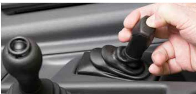
Palanca de elevación del volquete con botón de elevación
