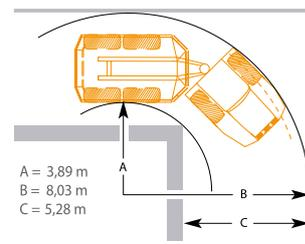
Anchura del DA30 con neumáticos 750/65 R25: 3208 mm
