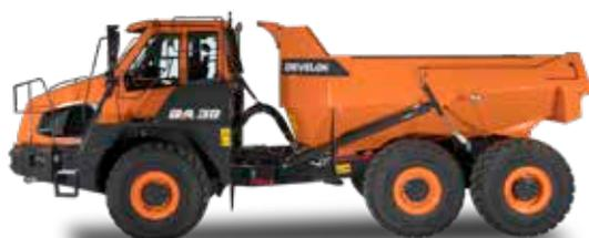
**Einfache Konstruktion:** Der permanente Sechsradantrieb liefert in Verbindung mit der dem Boden folgenden Tandemhinterachse und dem speziellen frontmontierten Drehring eine gleichmäßige Kraft- und Gewichtsverteilung sowie eine hervorragende Betriebsleistung. Der abfallende Heckrahmen besitzt einen niedrigen Schwerpunkt und verbessert die allgemeine Stabilität des Kippers, sodass die Mulde schnell und einfach gekippt werden kann, was die Produktivität steigert.
