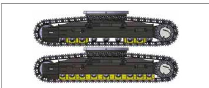
**Kettenschutze:** dienen der Sicherheit, Kettenausrichtung und besserer Fahrleistung der Maschine. 3 Kettenschutze pro Kette gehören zur Serienausrüstung der Modelle DX490LC-7K und DX530LC-7K (durchgehende Kettenschutze sind als Sonderausrüstung erhältlich); der DX420LC-7K hat 2 Schutze pro Kette (doppelte und durchgehende Kettenschutze sind als Sonderausrüstung erhältlich). Diese verschiedenen Kettenschutzoptionen bieten die jeweils optimale Lösung, auch für extreme Anwendungen.
