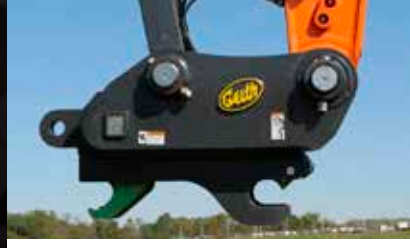
SCHNELLWECHSLER MIT BOLZENBEFESTIGUNG
