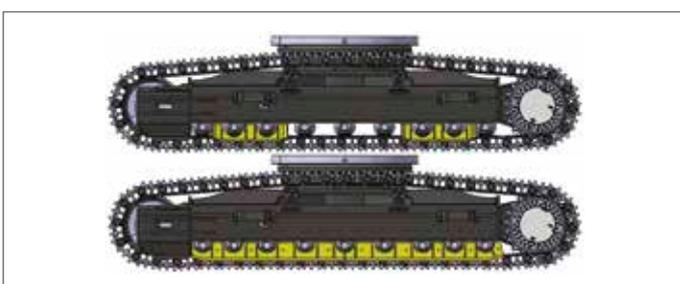
**Kettenschützer:** dienen der Sicherheit, Kettenausrichtung und besseren Fahrleistung der Maschine. 2 Kettenschützer pro Kette gehören zur Serienausrüstung (doppelte Kettenschützer und Kettenschützer über die volle Länge sind als Sonderausrüstung erhältlich). Diese verschiedenen Kettenoptionen bieten Ihnen die optimale Lösung auch für extreme Anwendungen.
