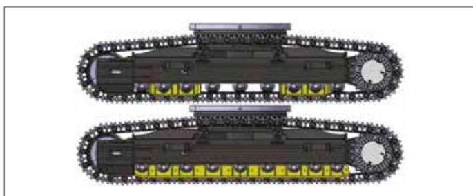
**Protectores de las orugas:** mejoran la protección, la alineación de las orugas y el rendimiento de la máquina en los desplazamientos. Incorporan 2 protectores por oruga de serie (protectores dobles y para toda la longitud de la oruga disponibles como opción). Estas opciones de protección constituyen soluciones óptimas para aplicaciones extremas.
