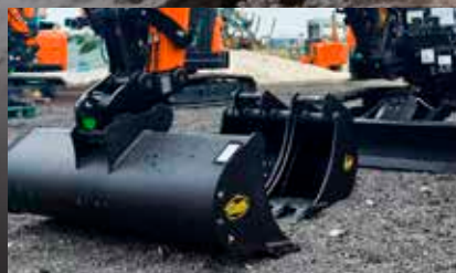
GODETS DE NIVELAGE / CURAGE
