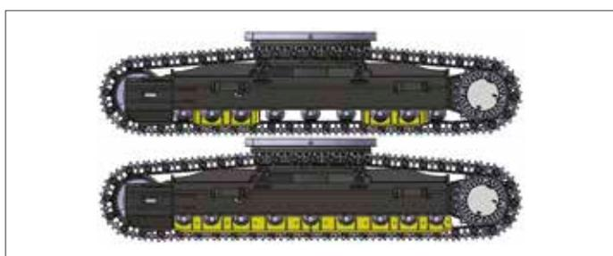
**Protectores de las orugas:** mejoran la protección, la alineación de las orugas y el rendimiento de la máquina en los desplazamientos. Incorporan 2 protectores por oruga de serie (protectores dobles y para toda la longitud de la oruga disponibles como opción). Estas opciones de protección constituyen soluciones óptimas para aplicaciones extremas.
