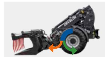
**Máxima presión en el pedal de freno de avance lento:** la máquina se mantiene parada y se obtiene plena potencia de motor para el sistema de trabajo hidráulico
