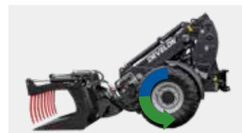
**Ligera presión en el pedal de freno de avance lento:** reduce la velocidad de desplazamiento y se obtiene mayor potencia de motor para el sistema de trabajo hidráulico
