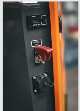
Le bouton d'arrêt d'urgence, stratégiquement positionné, permet d'interrompre instantanément toutes les fonctions de la machine et d'arrêter rapidement les opérations dans les situations critiques.
