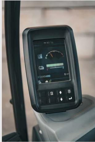
L'écran LCD couleur de 5,7", facile à lire, affiche les données clés de la machine et les options de commande. Il fournit un affichage graphique haute résolution, des données vitales de la machine et des écrans de diagnostic améliorés.
