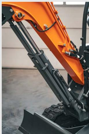
Les protections du balancier et du vérin de godet de la flèche sont conçues pour résister aux environnements difficiles des chantiers, garantissant ainsi la longévité et la durabilité de votre équipement.
