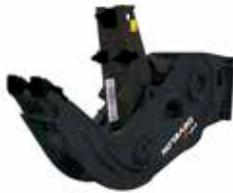
Progettato per migliorare potenza e durevolezza grazie a tecnologia all'avanguardia. I pulverizzatori fissi sono concepiti per lavori di demolizione primaria, riduzione del calcestruzzo secondaria e separazione del materiale.
