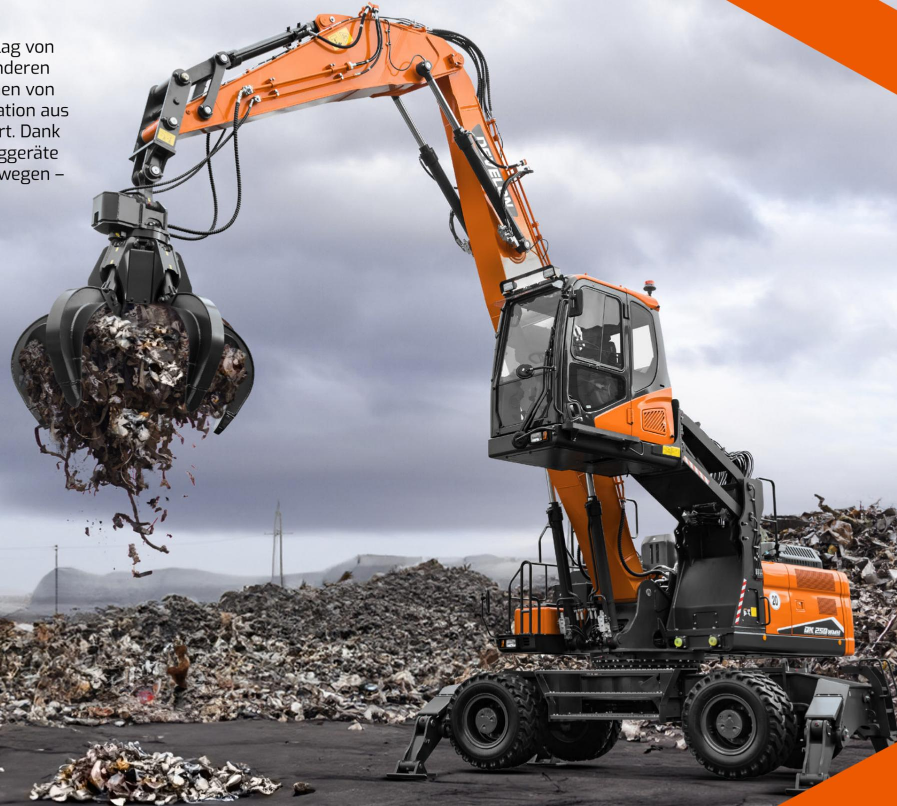
Die Materialumschlagmaschinen von Develon sind für Schutt, feste Abfälle, Wertstoffe und andere Schüttgüter konzipiert. Sie verfügen über eine leistungsstarke Hydraulik mit hoher Pferdestärke und Drehmoment, um große Mengen an Material zu bewegen. Dank der herausragenden Kraft des Löffelstiels können Sie schnell und präzise mehr Kubikmeter Material pro Tag bewegen.
