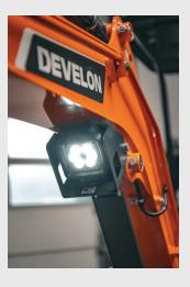
LED-Lampen mit hoher Leuchtkraft sorgen für eine bessere Sicht auf den Arbeitsbereich. So haben Sie die Arbeitsgruppe und insbesondere das Anbaugerät immer gut im Blick.
