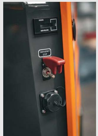
El botón de desconexión de emergencia estratégicamente situado interrumpe instantáneamente todas las funciones de la máquina, deteniendo rápidamente las operaciones en situaciones críticas.
