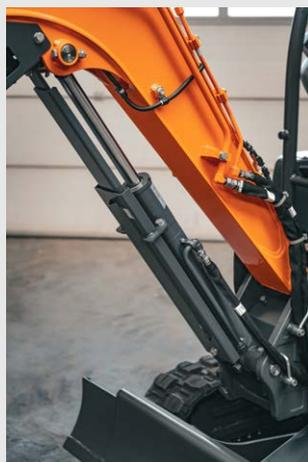
Le protezioni dell'avambraccio, del braccio e del cilindro della benna sono progettate per resistere agli ambienti di lavoro difficili, garantendo longevità e durezza alle apparecchiature.
