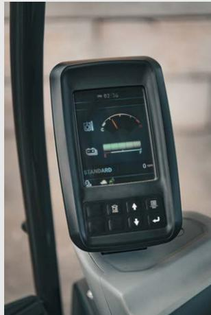
L'intuitivo schermo LCD a colori da 5,7 pollici visualizza i dati principali della macchina e le opzioni di comando. Il display offre un'elevata risoluzione, con schermate delle informazioni fondamentali e di diagnostica della macchina.
