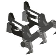
Die Develon-Planiertraube ist mit Leitungen für die einfache Integration eines optionalen parallelen 3-Zahn-Aufreißers ausgestattet. Der Aufreißer verfügt über ein paralleles Gestänge, das unabhängig von der Höhe einen konstanten Winkel zum Boden beibehält. Mit diesem Anbaugerät können Sie hartes, robustes Material vor dem Planieren schnell aufbrechen.
