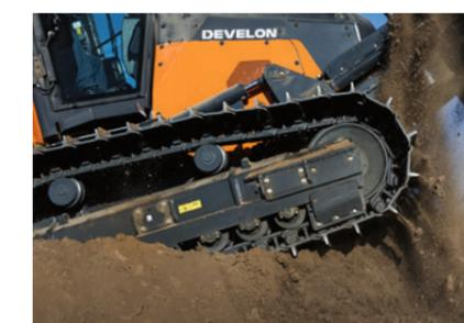
Die Doppelflansch-Laufrollen arbeiten außerhalb der Raupenkette, während die Einzelflansch-Laufrollen innerhalb der Kette sitzen. Diese Kombination sorgt dafür, dass die Kette auf dem Unterwagen bleibt, wodurch der Verschleiß verringert und der Fahrerkomfort verbessert wird.
