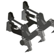
La hoja dózer Develon viene equipada con conductos para la fácil integración de un implemento opcional de diente ripper paralelo de 3 espigas. El implemento de diente ripper cuenta con un varillaje paralelo que ayuda a mantener un ángulo constante con respecto al suelo independientemente de la altura. Este implemento ayuda a romper rápidamente materiales duros y resistentes antes de la nivelación.
