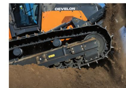
Los rodillos de doble pestaña actúan en el exterior de la cadena de la oruga, mientras que los rodillos de pestaña simple se sitúan en el interior. Esta combinación contribuye a garantizar que las orugas permanezcan en el tren inferior, lo que reduce el desgaste y mejora el confort del operador.
