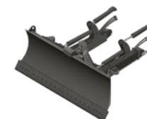
Scegli la configurazione con lama standard (XL) o con bassa pressione a terra (LGP). Consulta il riassunto delle specifiche del modello per i dettagli relativi alla capacità.
