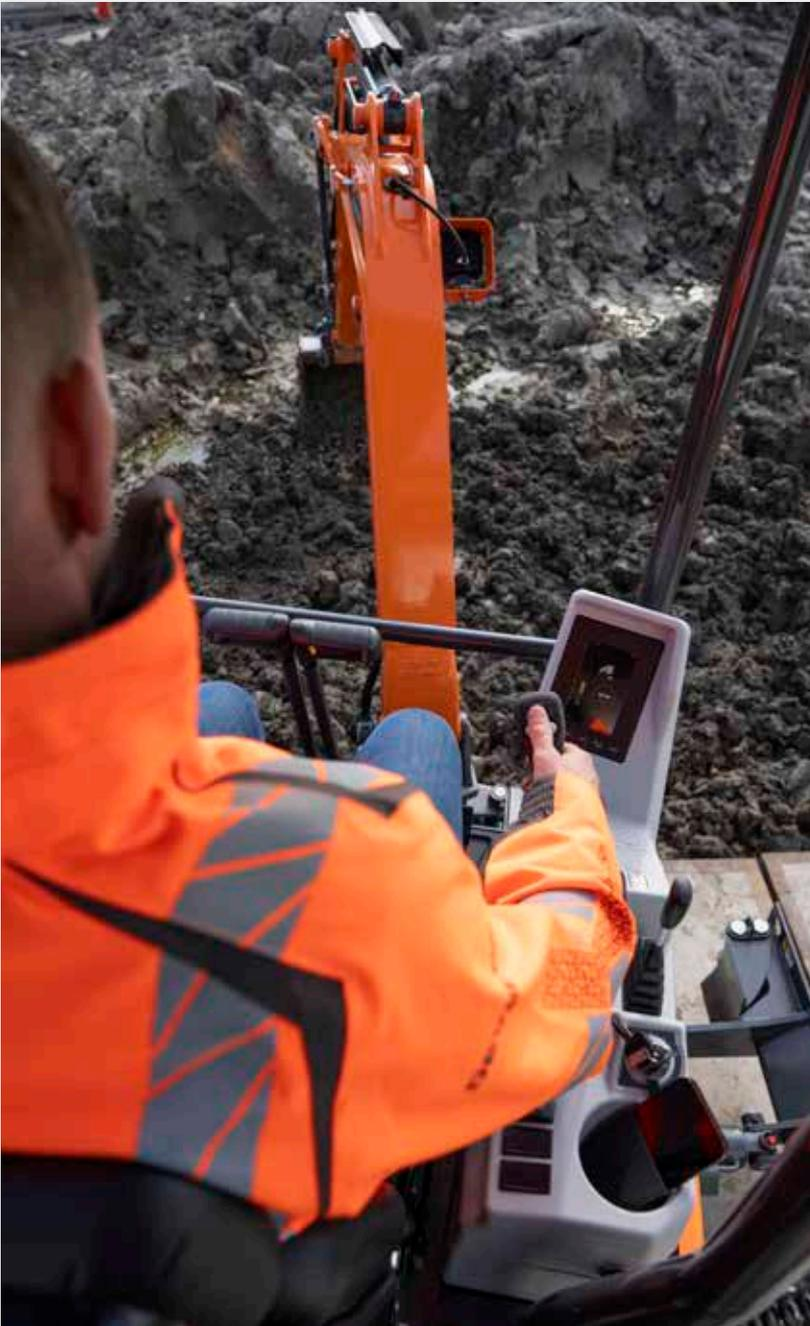
Hochgradig empfindliche und leichtgängige Joysticks sowie klare und praktisch angeordnete Bedienelemente ermöglichen sicheres, problemloses und zuverlässiges Arbeiten mit minimaler Anstrengung. Die proportionale Zusatzhydraulik bedeutet präzises Steuern, Laufruhe und effizientes Bedienen der Anbaugeräte.
