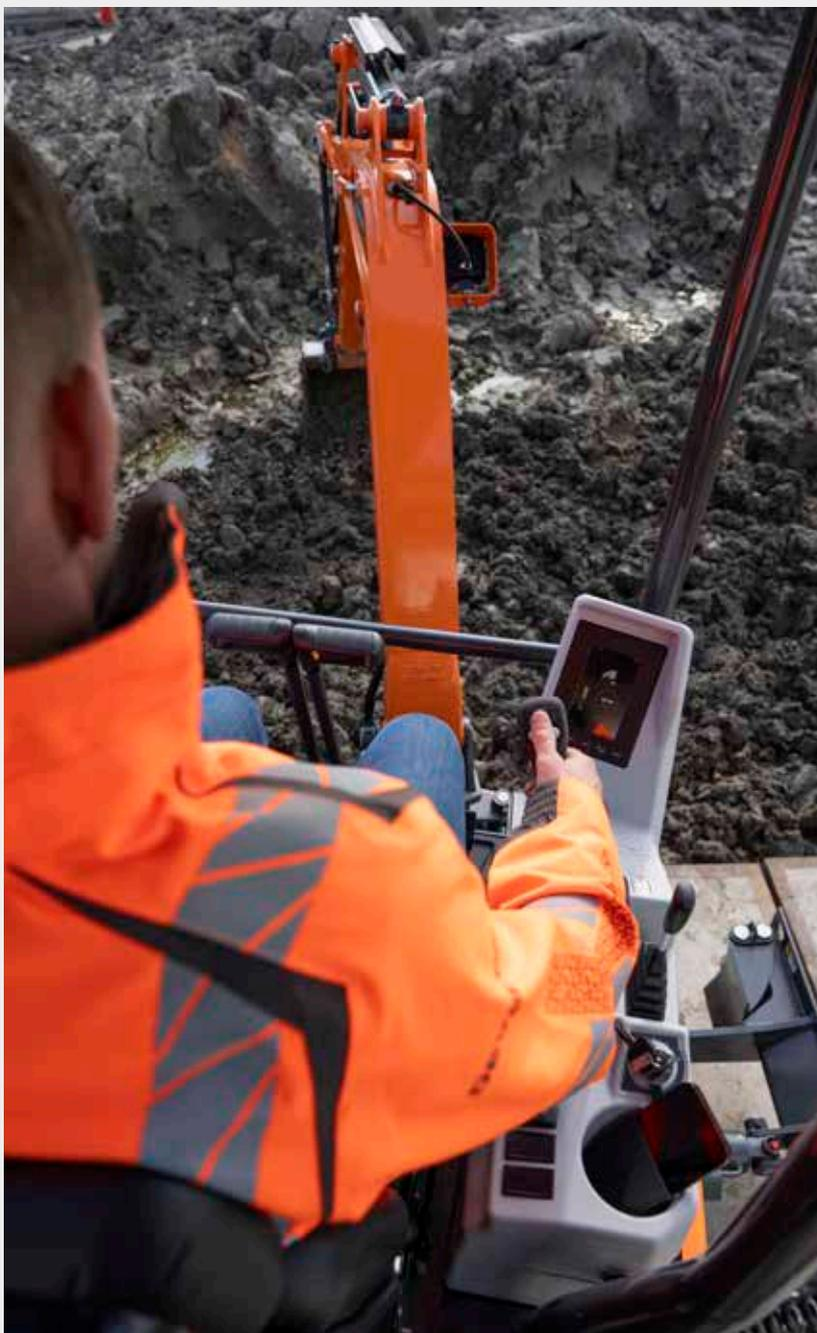
Los joysticks de alta sensibilidad y bajo esfuerzo y los cómodos y claros mandos le permiten trabajar con seguridad, suavidad y confianza con el mínimo esfuerzo. El caudal auxiliar proporcional le garantiza control de precisión, suavidad y eficacia al utilizar implementos.
