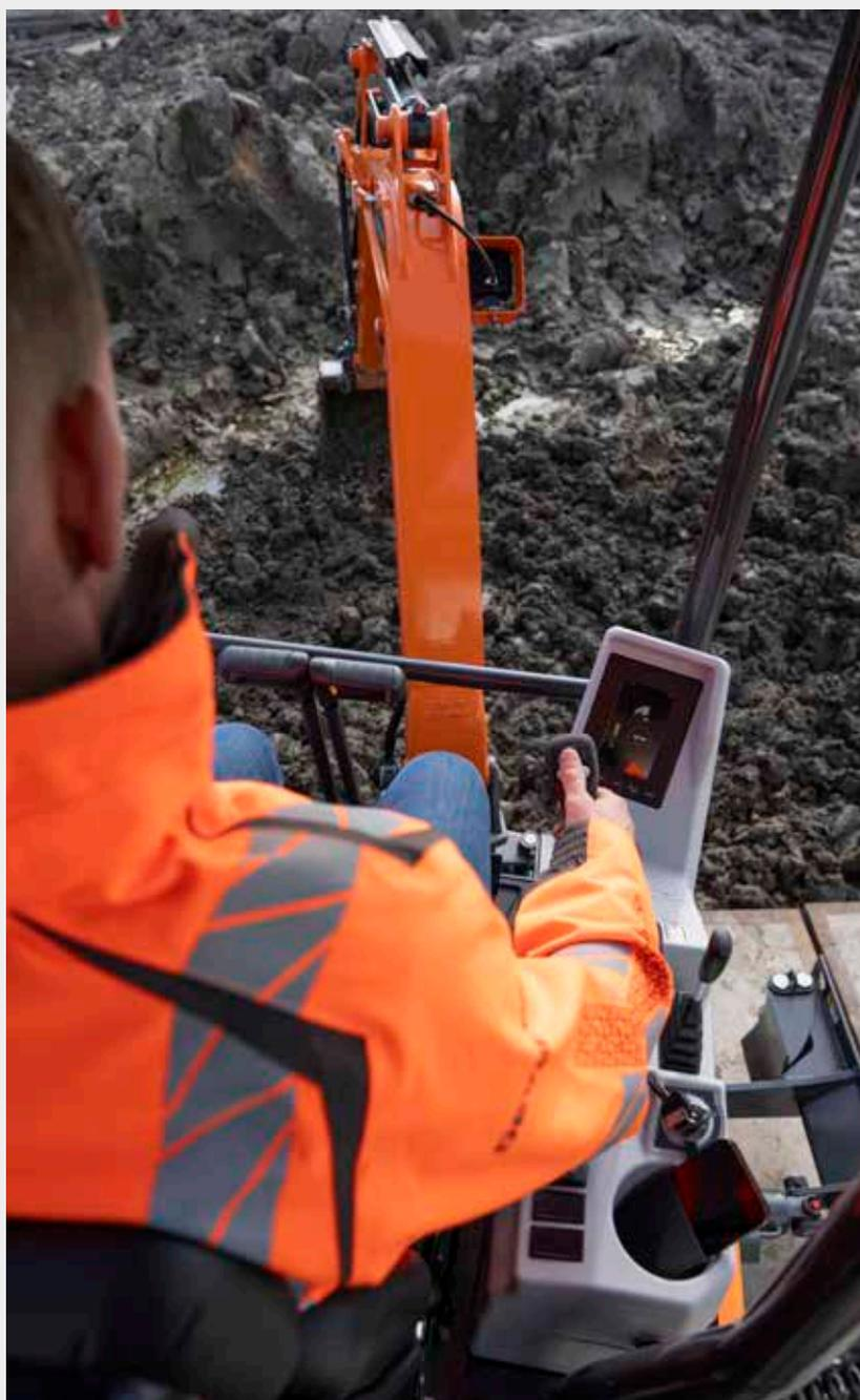
Joystick ad alta sensibilità e comandi collocati in posizione comoda da raggiungere permettono all'operatore di lavorare con semplicità, tranquillità e sicurezza con il minimo sforzo. La portata ausiliaria proporzionale rende l'utilizzo degli accessori idraulici più fluido, efficiente e preciso.
