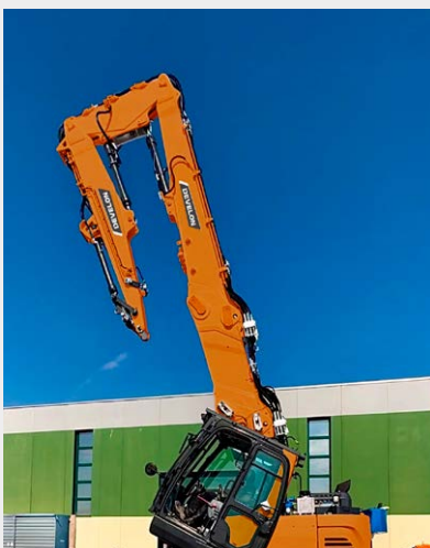
Flèche interchangeable, bras de démolition, extension de 2 m
