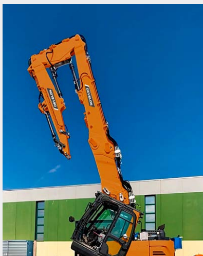
Braccio intercambiabile, bilanciere di demolizione, estensione 2 m
