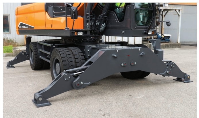
Châssis inférieur spécialement conçu avec de larges stabilisateurs pour accroître la stabilité
