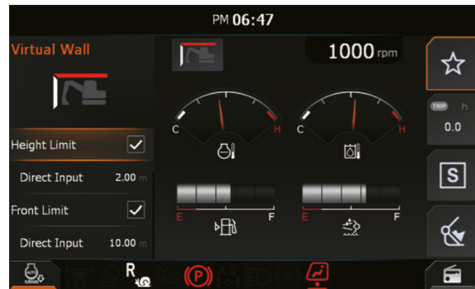
El sistema de pared virtual permite operar con seguridad en el interior de edificios
