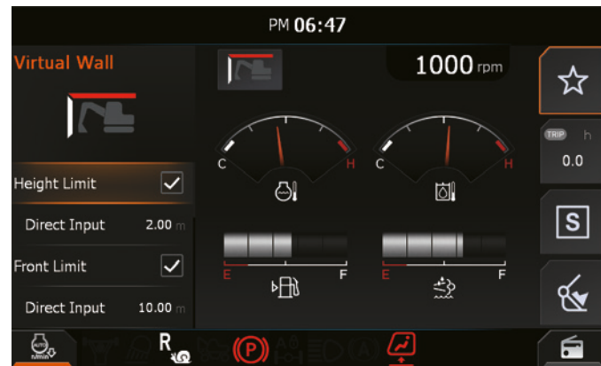
Il sistema di parete virtuale consente l'operatività sicura all'interno di edifici
