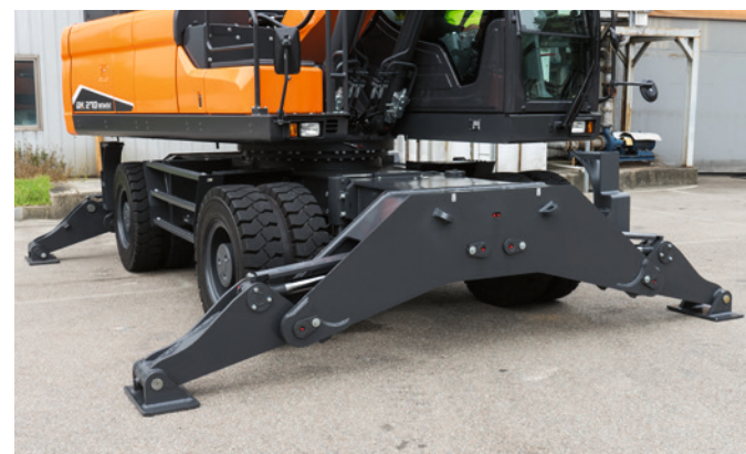
Carro specificatamente studiato con stabilizzatori ampi per una maggiore stabilità
