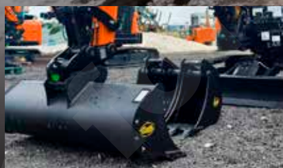
GODETS DE NIVELAGE / CURAGE
