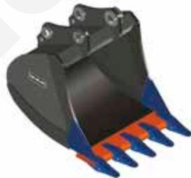
La cuchara para tareas pesadas está diseñada para excavaciones a gran escala en materiales densos como arcilla compactada, piedra caliza barrenada, grava u otro material con contenido limitado de roca.
