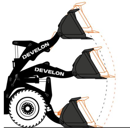
■ Z-Kinematik, Standard ■ Z-Kinematik, Hochhub
