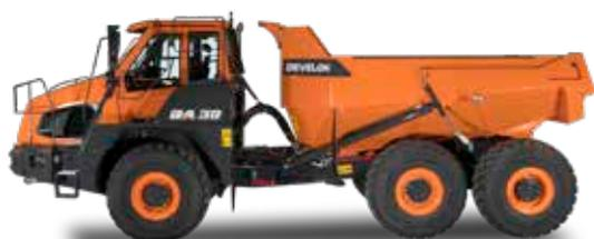
Con una larghezza inferiore a 3 m, il DA30 si sposta facilmente da un cantiere all'altro. E grazie al design compatto comune a entrambe le macchine è possibile usare una pala bassa più corta.
