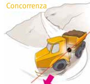
**Concezione semplice ed efficace:** La trazione a 6 ruote motrici permanente, insieme con il ponte posteriore tandem che segue il terreno e la speciale ralla di rotazione collocata anteriormente, assicurano distribuzione uniforme di pesi e potenza e prestazioni operative eccellenti. Il telaio posteriore inclinato riduce l'altezza del baricentro, migliorando così la stabilità complessiva del dumper e assicura un ribaltamento rapido e facile del cassone, con una migliore produttività.
